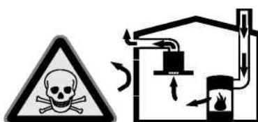
Источники пламени с подводом воздуха из помещения (например, работающие на газе, жидком топливе, дровах или угле нагреватели, проточные водонагреватели, бойлеры) получают воздух для сжигания топлива из помещения, где они установлены, а отработавшие газы отходят через вытяжную систему (например, вытяжную трубу) из помещения на улицу.
