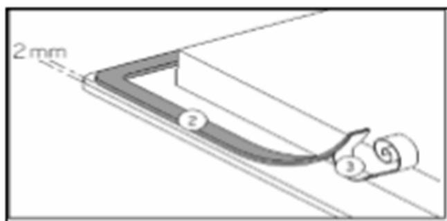
Приклейте уплотнение на расстоянии два (2) миллиметра от внешнего торца стеклокерамики, удалив защитный слой (3).
