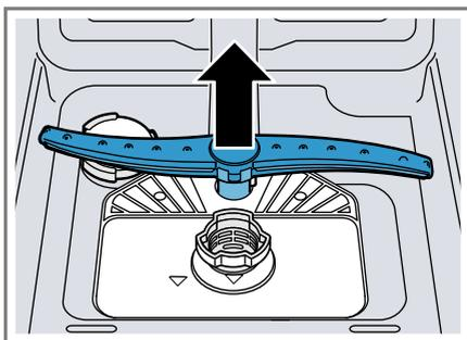
3. Под проточной водой проверьте выходные отверстия распылительных коромысел на отсутствие засорений и, если нужно, удалите посторонние предметы.
