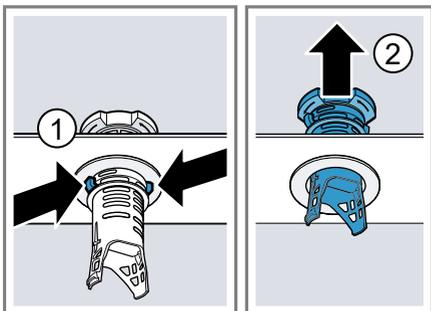
5. Промойте фильтрующие элементы проточной водой.
