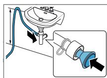
Заденьте соединение хомутом (12–22 мм).
