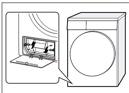
3. Снимите крышку теплообменника, потянув за ручку.
