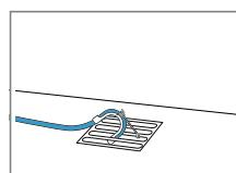
Полностью пропустите сливной шланг через изогнутый держатель и закрепите с помощью крепежного материала.
