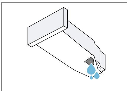
Обязательно задвигайте резервуар для конденсата перед использованием прибора.
