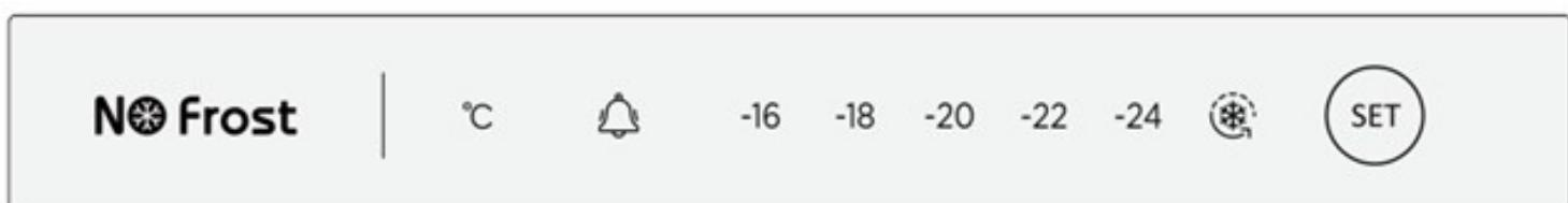
Температура может быть отрегулирована путем нажатия клавиши «**SET**». Каждый раз, когда нажимается клавиша «**SET**», индикатор текущего режима светится, пока загорается индикатор следующего режима. Если в течение 5 секунд не будет произведено действий с клавишей «**SET**», то указанная настройка режима будет автоматически зафиксирована. После фиксации настройки режима, температура будет контролироваться автоматически в соответствии с настройкой.
